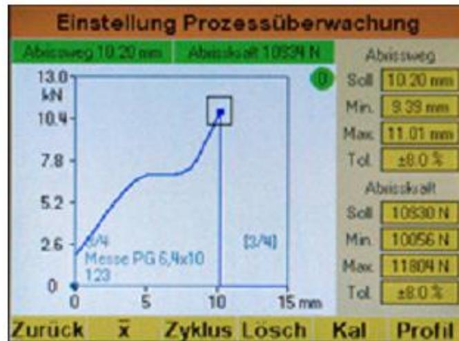
在設置過程中的功能圖：拉力 — 行程測量
